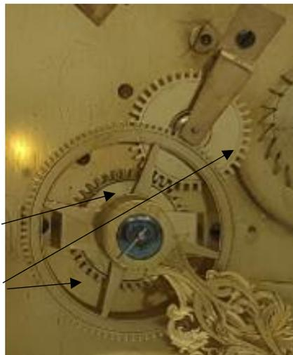
La détente des heures, la roue de déclenchement des heures, la détente des quarts
