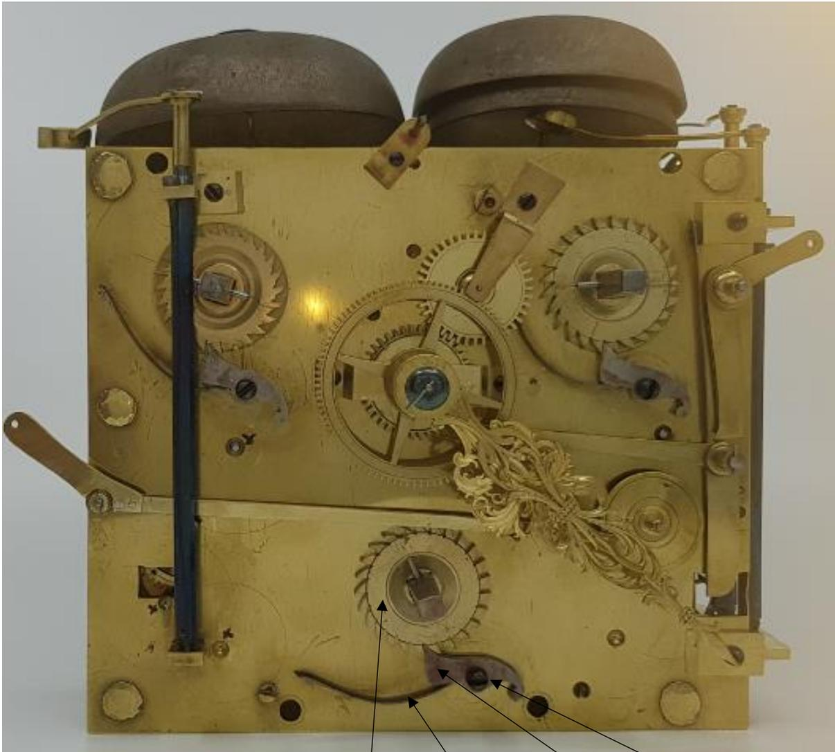
L'encliquetage est composé de 4 pièces : le rochet, le ressort de cliquet, le cliquet et sa vis à portée.
